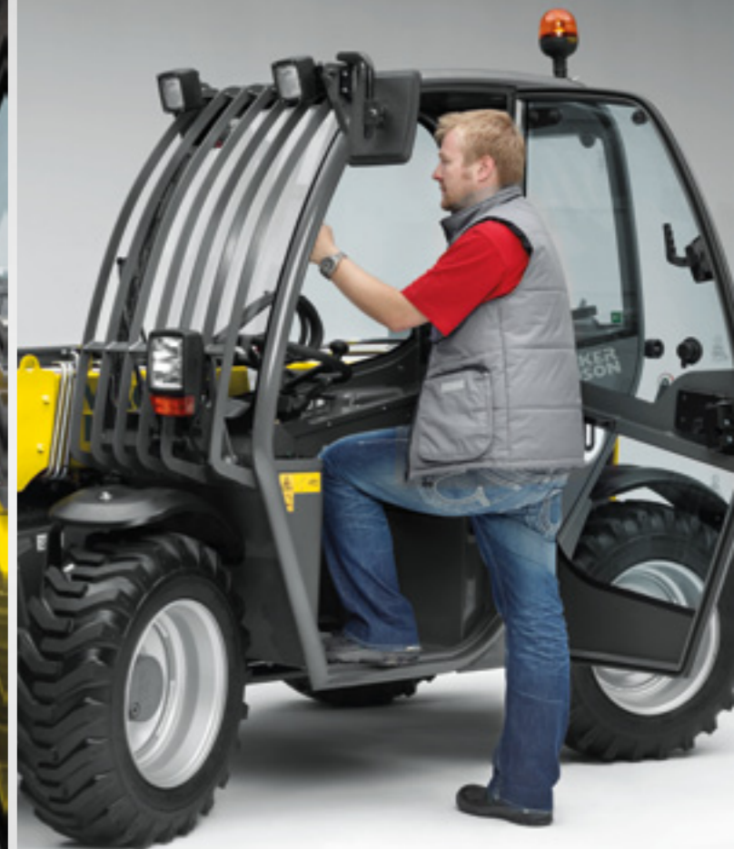
Mit einem Schritt kann man aufrecht in das Cockpit der Maschine gelangen. Die niedrige Einstiegshöhe macht es möglich.
