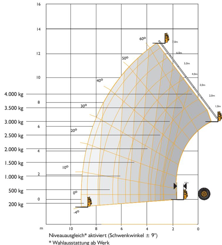
HUBLEISTUNG – STABILISATOREN AUSGEFAHREN
